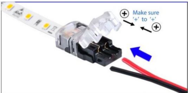
Das LED-Streifenende des Konnektors öffnen und die Anschlussleitung entsprechend der Polung des LED-Bandes einlegen
