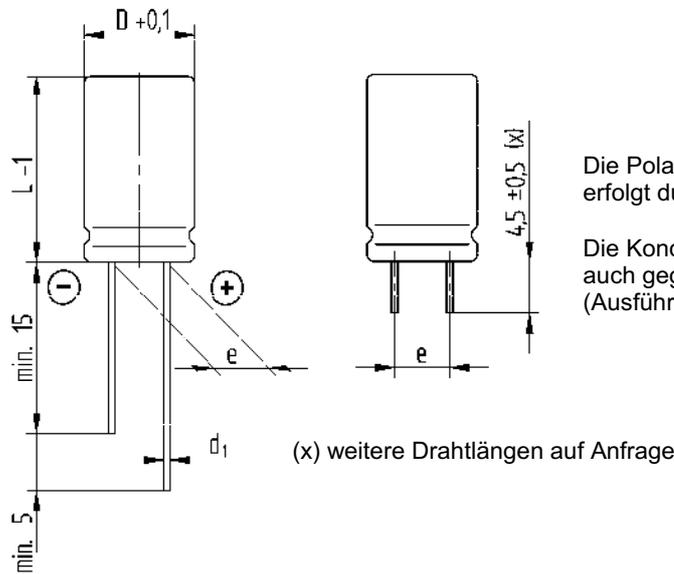
Die Polaritätskennzeichnung erfolgt durch das Stempelbild.
