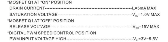
\*PWM INPUT FREQUENCY------ FPWM:18~30KHZ
