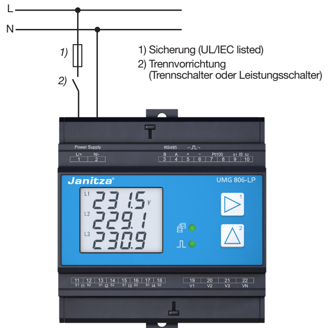
Abb. Anschluss Versorgungsspannung.
