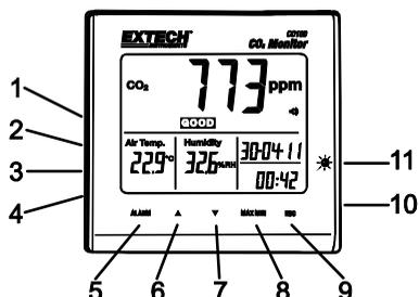
se mide un valor más alto. Presione este botón una vez más, aparece "MIN" y el valor mínimo de CO<sub>2</sub>, de temperatura y humedad se mostrará en la pantalla. Presione el botón ESC para salir de la función.
