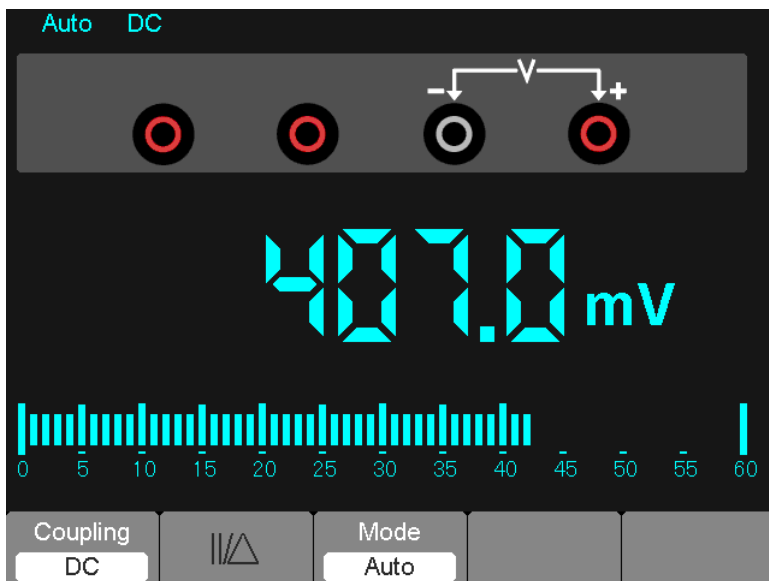
Figura 7-6 Medición de voltaje CD
