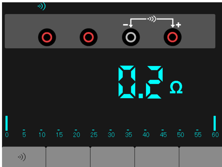
Figura 7-4 Medición de continuidad
