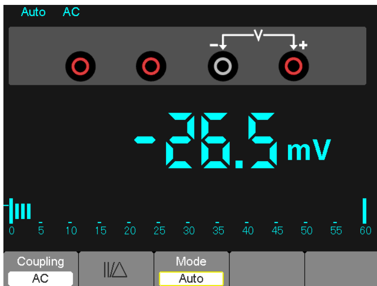
Figura 7-7 Medición de voltaje CA
