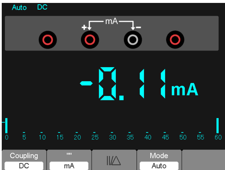
Figura 7-8 Medición de corriente CD para 600 mA
