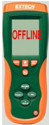
5. Si la comunicación falla, verifique las conexiones del cable USB (reemplace el cable si tiene falla), cierre todas las demás aplicaciones y seleccione otro puerto serial del menú hasta establecer la comunicación (espere varios segundos después de seleccionar un puerto COM nuevo).
