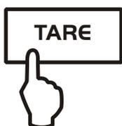
⇒ Descargar la balanza y apretar la tecla **TARE**, aparece el indicador cero.
