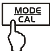
⇒ Descargar la balanza y apretar repetidamente la tecla **MODE** hasta que aparezca „PtArE“.
