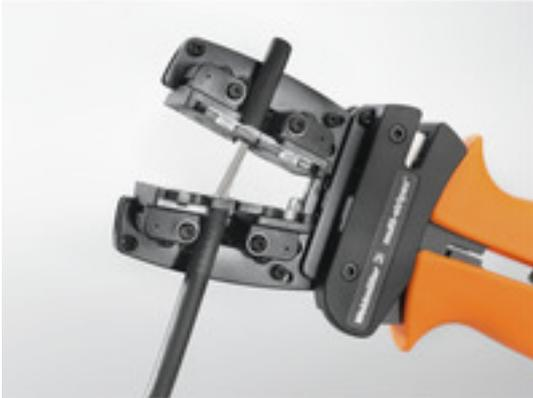
El **multi-stripax® PV** es una herramienta para cortar y desaislar que puede confeccionar diferentes cables fotovoltaicos sin necesidad de cambiar las cuchillas y, por tanto, acelerando el proceso de trabajo.
