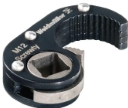
El accesorio Screwty® es compatible con los conectores redondos M12, con una dimensión exterior de la tuerca estriada de  $14,5 \pm 0,3$  mm. El par de apriete es de 0,8-1,2 Nm.
