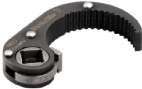
El accesorio Screwty® es compatible con los conectores redondos M23 personalizables y con los conectores redondos M23 sobremoldeados, con una dimensión exterior de la tuerca estriada de  $26,2 \pm 0,3$  mm. El par de apriete es de 2-2,5 Nm.
