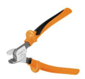
Herramientas para cortar cables de hasta 8 mm, 12 mm, 14 mm y 22 mm de diámetro exterior. La geometría especial de la cuchilla permite un corte sin estrangulamiento de conductores de cobre y aluminio, con esfuerzo físico mínimo. Las herramientas para cortar incluyen además aislamiento de protección sometido a pruebas VDE y GS de hasta 1000 V de conformidad con la normativa EN/IEC 60900.
