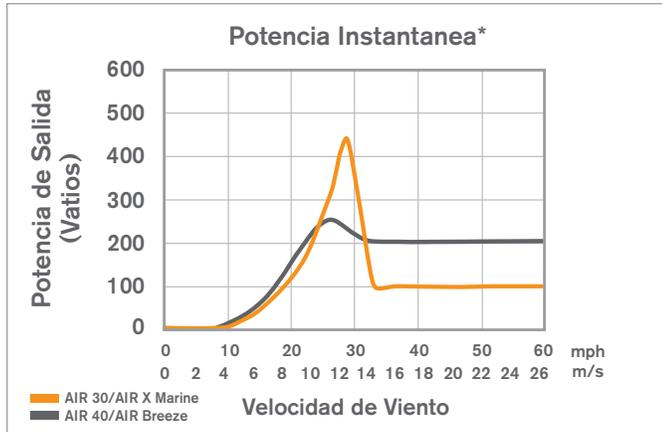
\*Entre los factores que afectan la potencia de una turbina se encuentran la turbulencia, temperatura ambiente y la altura sobre el nivel del mar.
