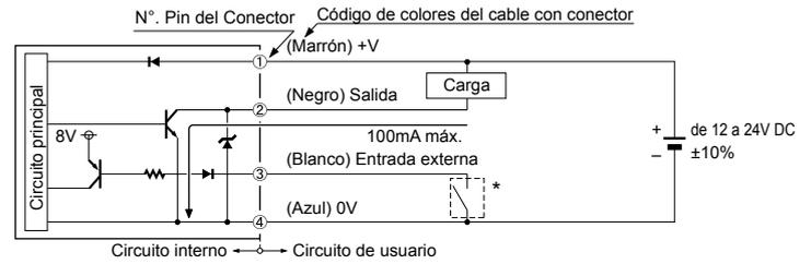
\* Contacto sin tensión o transistor NPN en colector abierto
