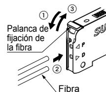
Para las fibras de reflexión directa coaxial, por ejemplo, FD-G4 o FD-FM2, insertar el cable de fibra mononúcleo en el alojamiento de emisión del haz "P" y el cable multinúcleo en el alojamiento de recepción del haz "D." Si se insertan al revés, la detección podría ser deficiente.
