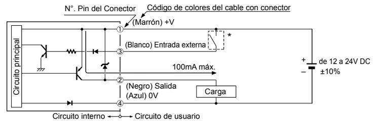
\* Contacto sin tensión o transistor PNP en colector abierto
