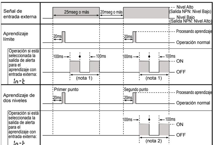
1. Si el margen no es suficiente, la salida pasará a ON/OFF cada 100 mseg. mientras que la señal de entrada externa esté a ON después del aprendizaje.
