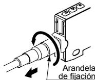
¡Comprobar que se ha aflojado completamente la arandela de fijación antes de quitar el cable! Una fuerza excesiva (15N·m o más) podría dañar el cable.
