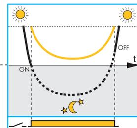
El innovador principio de compensación de la influencia de la luminaria evita molestos encendidos y apagados debidos a un montaje incorrecto
