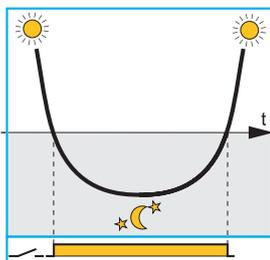
Funcionamiento correcto - siempre y cuando el sensor fotosensible se pueda proteger de los efectos del encendido y apagado de la luminaria que conecta
