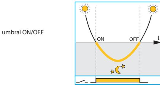
Nivel de apagado = nivel de encendido. El circuito patentado de histéresis cero garantiza el encendido y apagado de manera fiable sin derroche de energía.
