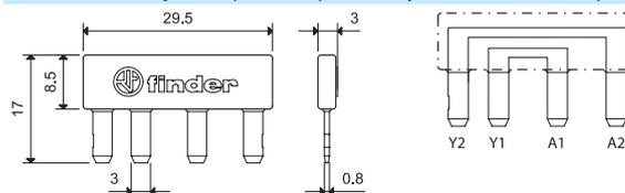
Para la conexión directa de la salida auxiliar del 11.91 (Y1-Y2) a los terminales de alimentación del 19.91 (A1-A2)
