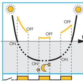
Funcionamiento incorrecto (ciclos de encendidos y apagados de la lámpara)
