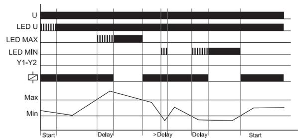
Si se selecciona la función memoria de defecto (LATCH) realizando un puente entre Y1-Y2, el relé de salida permanecerá desconectado después de un disparo por máxima o por mínima intensidad, incluso si la intensidad cae por debajo del valor (MIN) o sube por encima del valor (MAX) ajustados, respectivamente.
