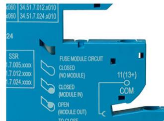
1. Con el módulo portafusibles insertado, después de quitar el tapón, el fusible se conecta eléctricamente en serie con el común del contacto de carga de la interfaz (borne 11 en las ejecuciones EMR, 13+ en las ejecuciones SSR, 15 en el temporizador EMR, 15+ en el temporizador SSR). Este estado se visualiza mediante el testigo/indicador.
