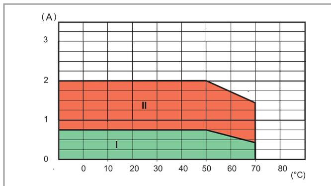
I: SSR instalados en bloque (sin separación entre zócalos)
