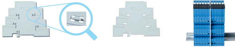
2. Manteniendo las pestañas en su lugar proporciona una separación de 6.2 mm. Con un simple corte (con tijera) del segmento/segmentos pertinente, permite la interconexión a través del separador de 2 grupos diferentes de interfaces, utilizando los puentes estándar.
