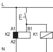
• Admite la Señal de mando (borne B1), así como el de una segunda carga: relé, telerruptor, etc..., con el mismo contacto.
