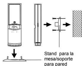
El transmisor termo-higro puede ser colocado en cualquier superficie plana usando el soporte que se desdobra como un stand o como la base para fijarlo en la pared.
