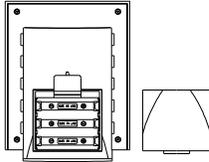
1. Inserte el dedo o otro objeto sólido en el espacio en la parte superior central del compartimiento de pilas y deslice hacia arriba para quitar la cubierta.
