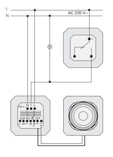
Si la habitación no dispone de ninguna fase continua, alternativamente se puede establecer la conexión de la radio empotrada a través de la fase conmutada. En ese caso, la radio empotrada sólo se puede poner en funcionamiento con la luz encendida
