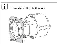
El anillo de fijación del altavoz está cubierto por una película que se encarga del aislamiento entre el altavoz y la abertura acústica anterior. Esta junta del anillo de fijación no debe retirarse v. excepto por las penetraciones de los tornillos de fijación, no debe deteriorarse, de lo contrario podría periudicar la calidad de reproducción de los tonos graves.
