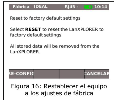
Figura 16: Restablecer el equipo a los ajustes de fábrica
