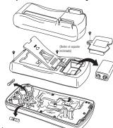
ADVERTENCIA: Para evitar riesgos de electrocución, desconecte los cables de las puntas de prueba antes de abrir la tapa del compartimiento de la batería
