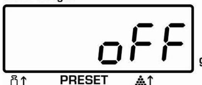
**Check off** – Control de tolerancia apagado
