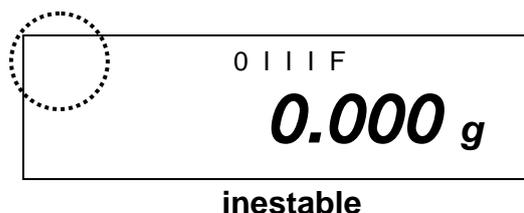
Si en la pantalla aparece la indicación de estabilidad [o], significa que la balanza se encuentra en un estado estable. Si el estado de la balanza es inestable, el símbolo [o] vuelve a desaparecer. Condiciones estables se obtienen con el montaje de un guardabrisas (para el montaje véase cap. 5.2.4)
