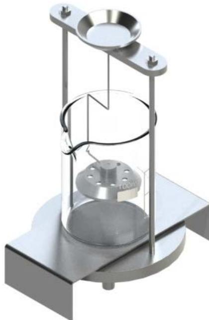
Dibujo: Set para la determinación de la densidad KERN YDB-01 con el cestillo sumergible para cuerpos flotantes
