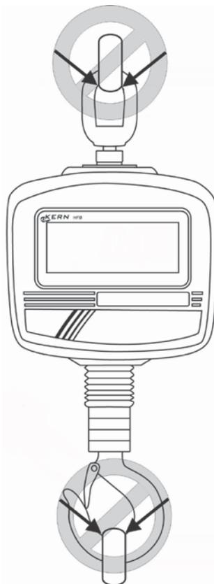
**No usar elementos para colgar la carga demasiado grandes que no aseguren una suspensión de la balanza por un punto.**
