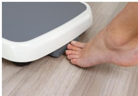
⇒ La balanza procede al autodiagnóstico. La balanza está lista para el pesaje tras la aparición de la indicación de la masa „0.0 kg”.
