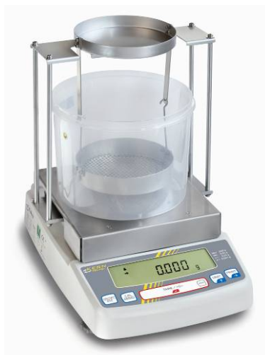
Dibujo 1: Set para determinación de densidad KERN PBS-A04
