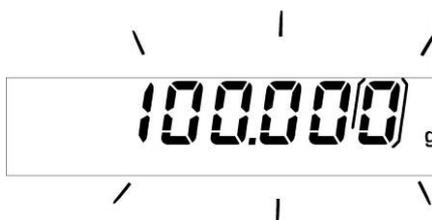
⇒ **Mientras** parpadea la indicación colocar la pesa de calibración en el centro del plato.
