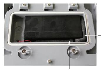
⇒ Colocar la batería de modo que no se mueva (bloquearla con el bloque de espuma).
