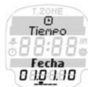
El cronómetro sirve para medir periodos de tiempo independientes de un entrenamiento. Para iniciar su cronómetro pulse → START. Siga las indicaciones que aparecen en la pantalla.
