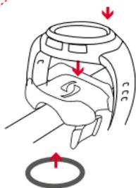
Montaje del soporte de bicicleta. Apoye el soporte en el manillar.
