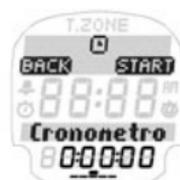
La cuenta atrás descuenta hasta "0" un periodo de tiempo que puede configurarse libremente y entonces emite una alarma acústica y óptica. Para ajustar la cuenta atrás pulse la tecla de navegación → CHANGE. Siga las indicaciones que aparecen en la pantalla.
