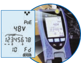
Detección de servicios
