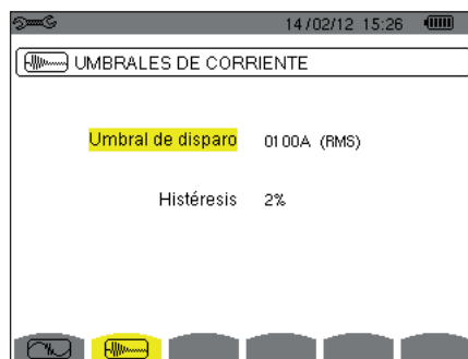
Figura 30: la pantalla Umbrales de corriente de inserción en el menú Modo corriente de inserción
