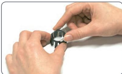
4. Vuelva a colocar la pieza intermedia en el ocular. Según el ocular, es preciso presionar firmemente la pieza intermedia o girarla en el sentido de las agujas del reloj.
