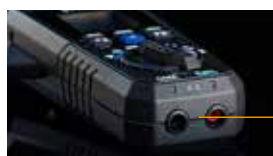
Entrada de cables de prueba
