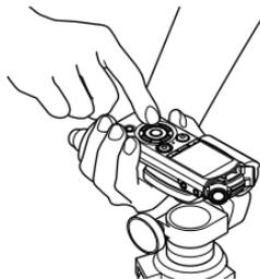
Si el tornillo de fijación del trípode y el adaptador no se pueden retirar, saque la pieza que se muestra en la figura utilizando una llave de un tamaño M10 u otra herramienta similar.
