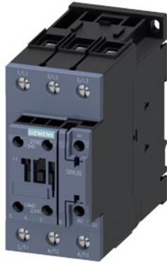
Leistungsschütz, AC-3 40 A, 18,5 kW / 400 V 1 S + 1 Ö, AC / DC 20-33 V, mit Varistor, 3-polig, Baugröße S2, Schraubanschluss
