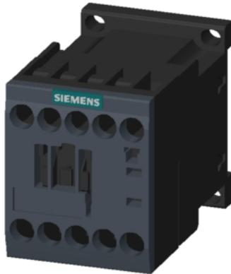
Leistungsschütz, AC-3 16 A, 7,5 kW / 400 V 1 Ö, AC 230 V, 50/60 Hz 3-polig, Baugröße S00 Schraubanschluss
