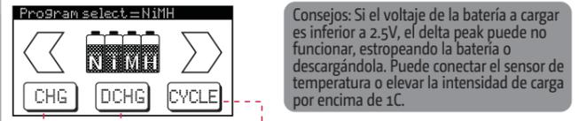
Consejos: Si el voltaje de la batería a cargar es inferior a 2.5V, el delta peak puede no funcionar, estropeando la batería o descargándola. Puede conectar el sensor de temperatura o elevar la intensidad de carga por encima de 1C.
