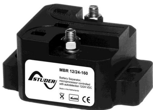
Los separadores de batería (MBR) son contactos mecánicos de fuerte potencia controlados por microprocesador. Un MBR puede utilizarse cuando un sistema se compone de 2 baterías (una batería de arranque y una batería auxiliar) o de una batería de arranque y accesorios en corriente continua (lámparas 12Vdc, etc.), como por ejemplo en los barcos o caravanas.
