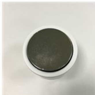
Imán sobre el soporte de montaje de la cámara
