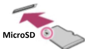
3. Coloque la tarjeta de memoria, orientada adecuadamente, en la sección correcta de la bandeja. Al insertar la tarjeta microSD, asegúrese de que los contactos metálicos estén hacia abajo. Inserte la tarjeta hasta escuchar un sonido de clic, indicativo de que ha encajado correctamente en su lugar. Para liberar la tarjeta, empújela, libérela y tire de ella.
