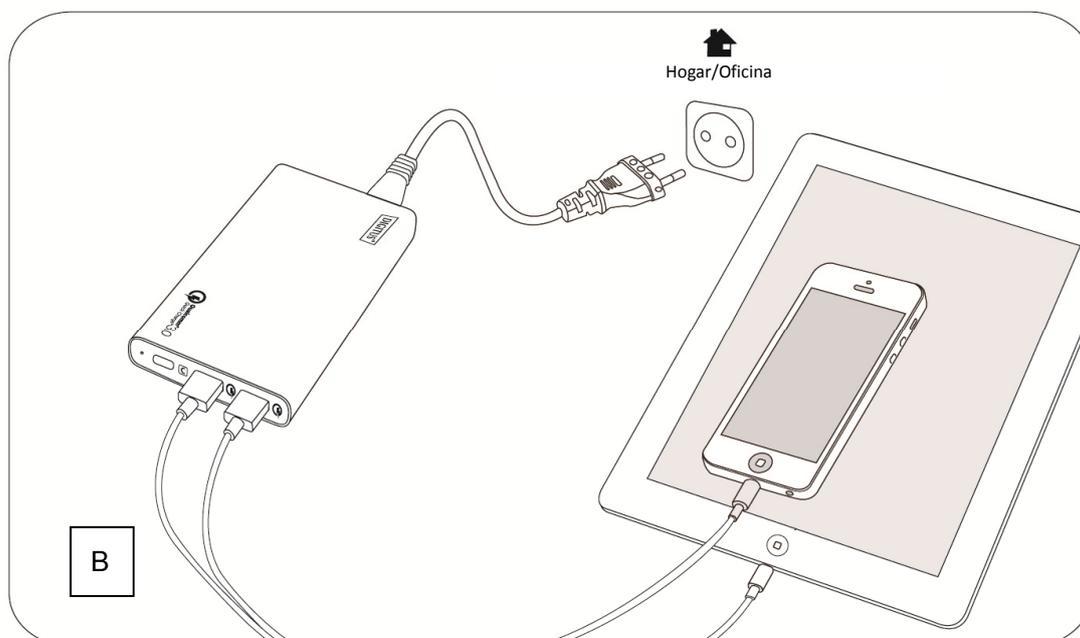
**Precaución:** Este adaptador soporta una potencia máxima de 40W. Si la potencia empleada supera los 40W, el adaptador activará su protección contra sobrecarga. Cuando vuelva a conectarlo retomará su funcionamiento normal.
