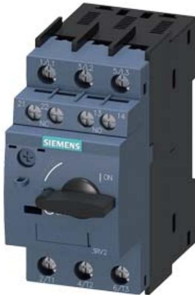
tipo especial Interruptor automático tamaño S00 para protección de motores, CLASE 10 Disparador por sobrecarga con retardo según intensidad 5,5...8 A Disparador de cortocircuito 104 A borne de tornillo poder de corte estándar con bloque de contactos auxiliares transversal 1 NA+1 NC Temperatura ambiente -50 °C 500 ciclos de maniobra
