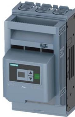
SENTRON, Sicherungslasttrennschalter 3NP1, 3-polig, NH00, 160 A, für Aufbau und Einbau auf Montageplatte, Flachanschluss, Sicherungsüberwachung: elektronisch EFM20, Abdeckebene 45mm
