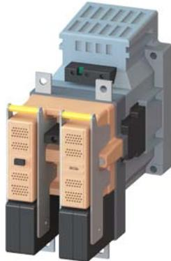
Schütz, Baugröße 12, 2-polig, DC-3 und 5, 400A Hilfsschalter 22 (2 NO + 2 NC) AC 110V 50Hz/AC 132V 60Hz AC-Betätigung AC-Betätigung
