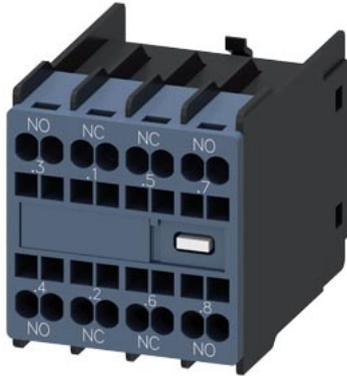
Hilfsschalter frontseitig, 2 S + 2 Ö Strombahn 1 S, 1 Ö, 1 Ö, 1 S für 3RH2 und 3RT2 Federzuganschluss .3/.4, .1/.2, .5/.6, .7/.8
