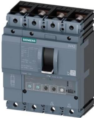
Leistungsschalter 3VA2 IEC Frame 160 Schaltvermögenklasse H Icu=85kA @ 415V 4-polig, Anlagenschutz ETU350, LSI, In=40A Überlastschutz Ir=16A...40A Kurzschlusschutz Isd=1,5...10 x Ir, li=12 x In N-Leiterschutz einstellbar (OFF, 100%) Schraubenflachanschluss
