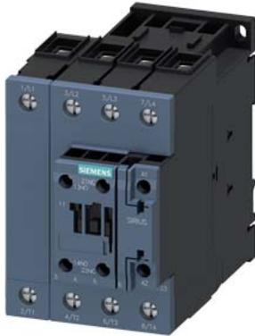
Schütz, AC-3, 50 A/22 kW/400 V, S2, 4-polig, AC/DC 20-33V, mit Varistor, 1S+1Ö, Schraubanschluss
