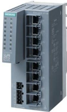
SCALANCE XC108, unmanaged IE Switch, 8x 10/100 Mbit/s RJ45 Ports, LED-Diagnose, Fehlermelde- Kontakt mit Set-Taster, redundante Spannungsversorgung Handbuch als Download verfügbar .
