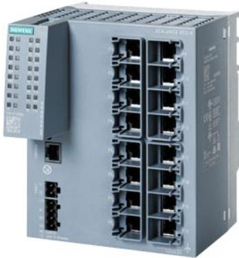
SCALANCE XC216 managebarer Layer 2 IE Switch; IEC 62443-4-2 zertifiziert; 16X 10/100 Mbit/s RJ45-Ports; 1x Konsolen-Port, Diagnose-LED; redundante Spannungsversorgung; Temp.-Bereich-40°C bis +70°C; Montage: Hut-/S7-Profileschiene/Wand Redundanzfunktionen Office Features (RSTP, VLAN, ...); PROFINET IO-Device; Ethernet/IP-konform; C-PLUG Schacht,.
